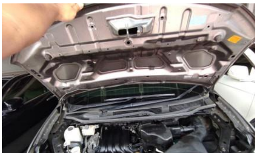
Tiang Kap Mesin Tidak Ada
