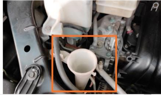
Tutup Air Wiper Tidak Ada
